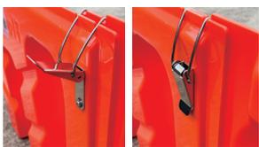
従来品は接続する場合、上部ソケットに上部フックをはめ込み横にスライドさせる必要があります。簡単な構造なのですが、緊急時に設置するには少々手間取ることがありました。そこで、Flood Guard Fはフック式を採用。スライド式に比べ初見の方でも接続方法が理解可能で、容易に設置できます。また、接続強度も格段にアップすることに成功しました。
