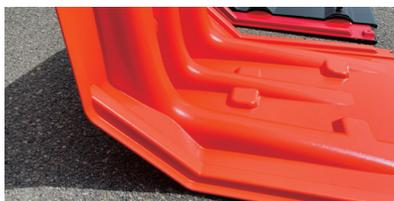
従来品(フロード・ガードD型)は本体と本体の接続部に90度L字の部位があります。この部位のパッキンは他の部位のパッキンより圧力が均等にかからず、隙間ができやすく漏水の原因の一つでした。そこで、接続部のL字部位を無くし、斜めにデザインすることで従来品に比べパッキンを均一に圧縮することができ、漏水が大幅に軽減されました。また、側面の止水ゴムを廃止しメンテナンスと保管のしやすさも向上しています。
